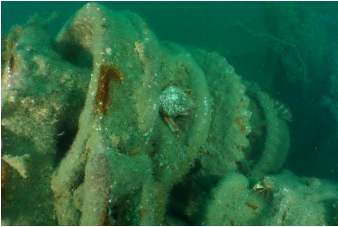
Les treuils d'étrave ou sont encore à poste les chaînes du mouillage.
