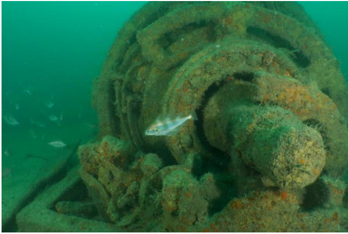
A l'avant du moteur, le générateur d'électricité servant à alimenté les câbles de déminage magnétique.
